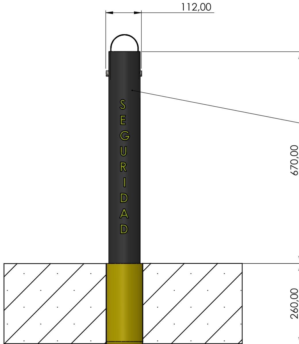
Caño de A106 de 4" con sistema de anclaje para flujo vehicular lento (velocidades <40km/h). En base al diametro y tamaño su aplicacion principalmente es para estacionamientos, parques, cocheras y parada de camiones
